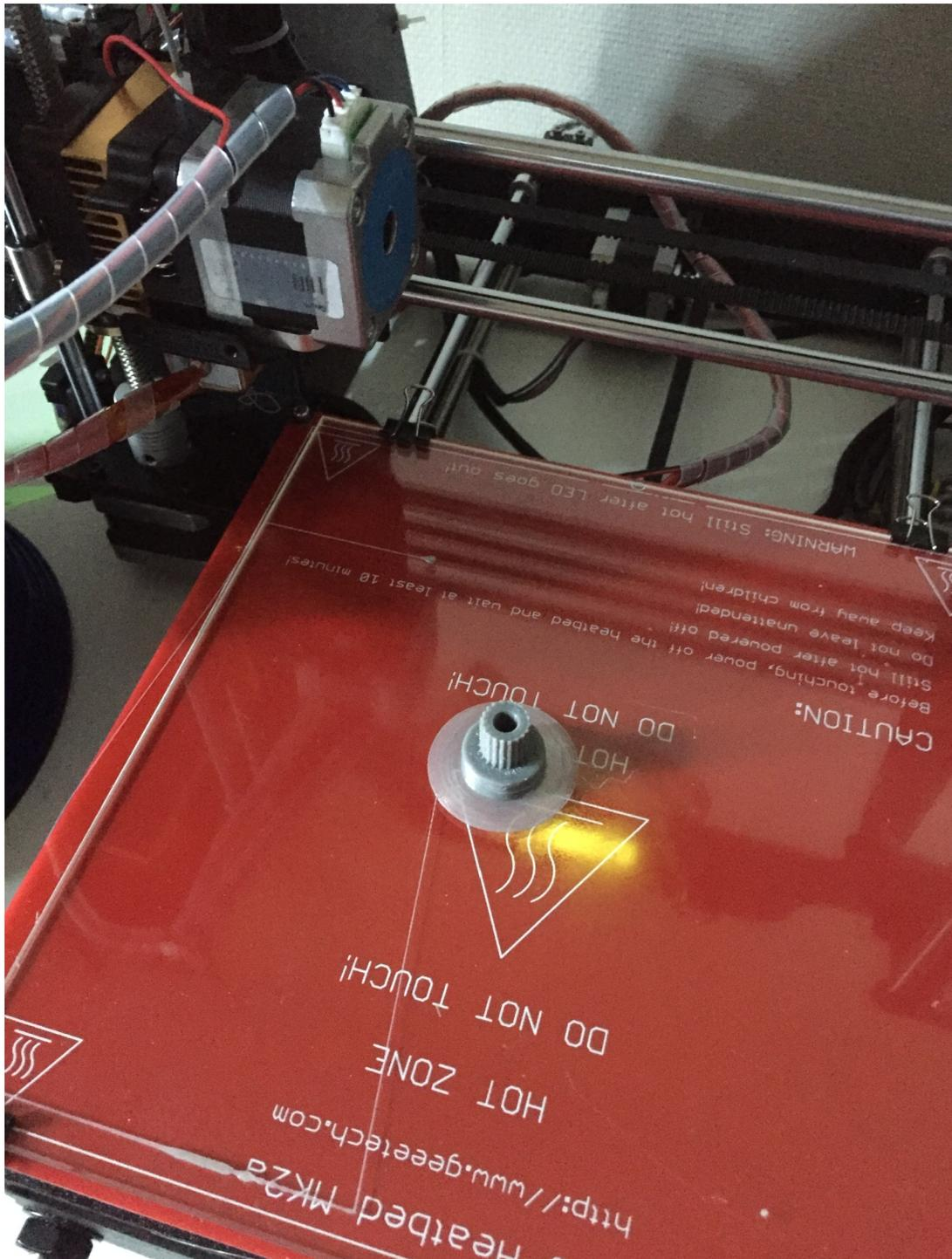
C'est fini : la bordure à la base de la pièce sert à augmenter l'adhésion sur la plaque de l'imprimante
